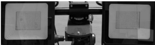
图 3 可移动机器人双目视觉图像采集系统
