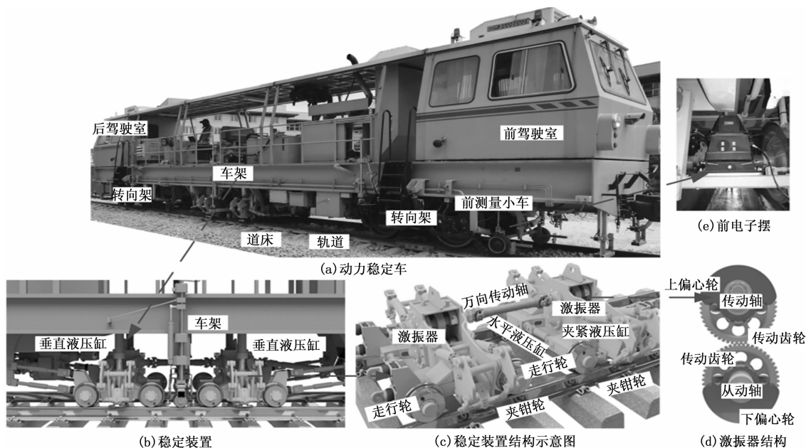
图 1 动力稳定车示意图
