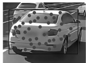
图 2 视频图像中小目标车辆的雷达识别样点标定
