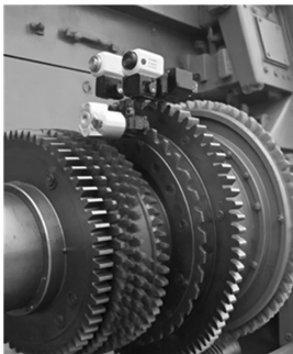
图 2 振动加速度传感器监测现场
