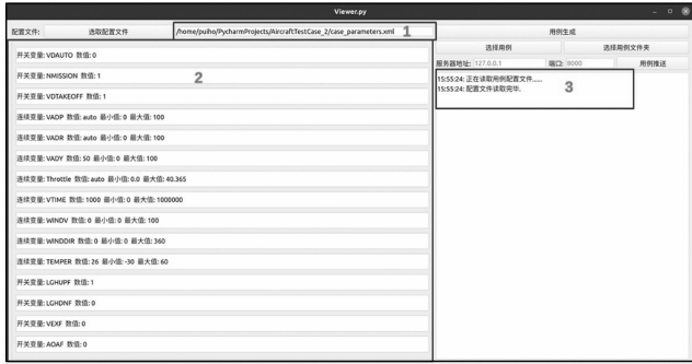
图 11 测试用例生成人机交互软件界面
