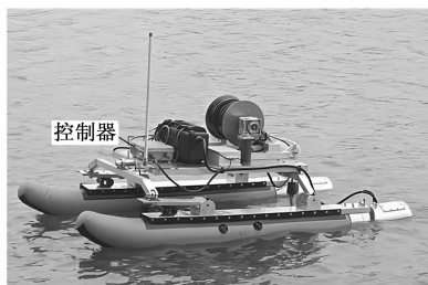
图 5 无人船中航行控制器安装实景
