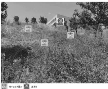
图 10 2 号坡体监测点布设图
