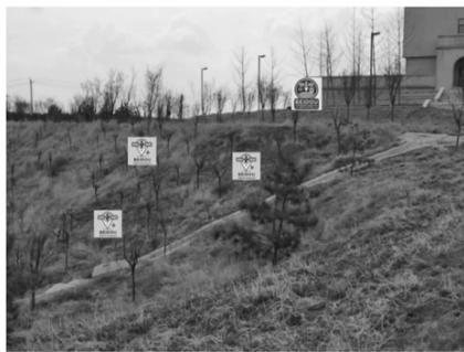
图 9 1 号坡体监测点布设图
