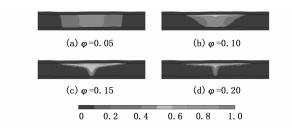
图 10 不同孔隙度条件下第 15 年地层内纵向中间截面 CO<sub>2</sub> 饱和度分布图
