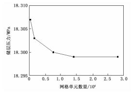
图 3 CO<sub>2</sub> 持续注入 25 年后咸水层压力 随网格单元数量的变化曲线
