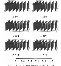
图 6 CO<sub>2</sub> 饱和度随时间变化的分布云图
