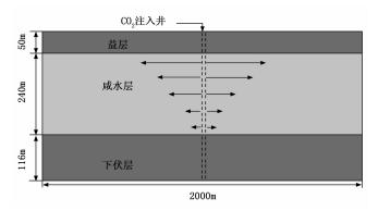
图 1 石千峰组咸水层 CO。地质封存概念模型
