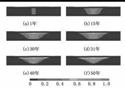
图 7 地层内纵向中间截面 CO<sub>2</sub> 随时间变化的分布云图
