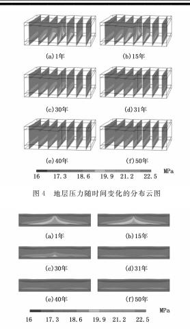
图 5 地层内纵向中间截面压力随时间变化的分布云图
