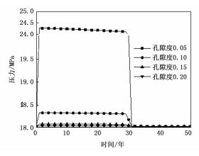
图 8 不同孔隙度条件下咸水层压力随时间的变化曲线
