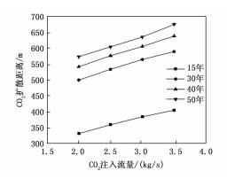
图 16 CO<sub>2</sub> 扩散距离随注入流量的变化趋势
