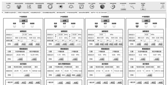
图 12 某试验油源系统远程监控界面
