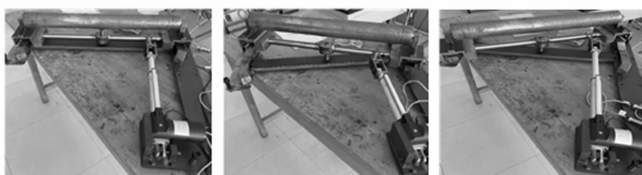
(a) 皮带原始位置 (b) 皮带左移诊断设置 (c) 皮带右移诊断设置
