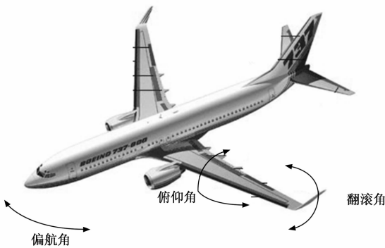
图 1 飞行器标准姿态角示意图
