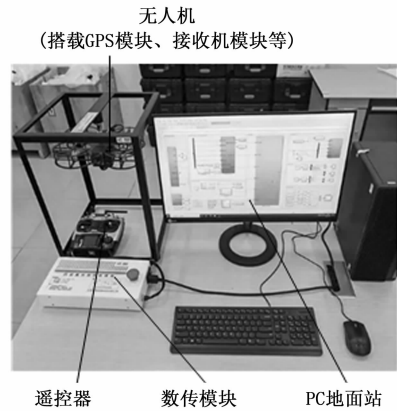
图 5 四旋翼无人机飞行姿态控制实验平台示意图
