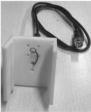
图 9 光电夹具实物图
