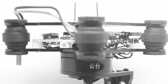
图 5 连接运动控制板与云台
