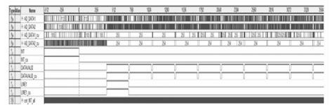
(b) 双探测器 IWR+非CDS 工作时序图
