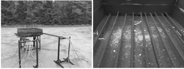
图 1 文献 [13] 管道燃气快烤装置示意图
