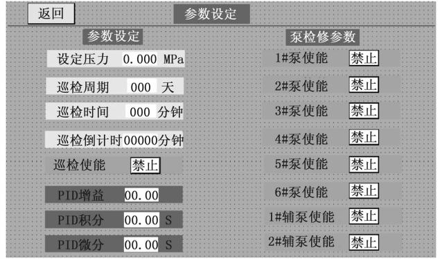
图 6 冷却供水变频恒压系统参数设定界面
