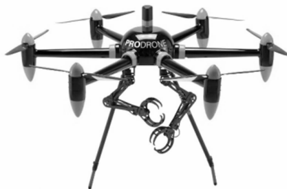
图 3 日本 Prodrone 公司的无人机机械臂
