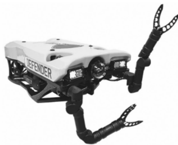
图 2 美国 VideoRay 公司的水下机械臂系统
