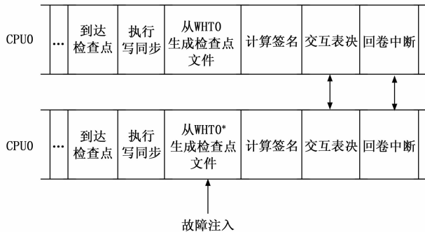
图 10 检查点文件故障注入
