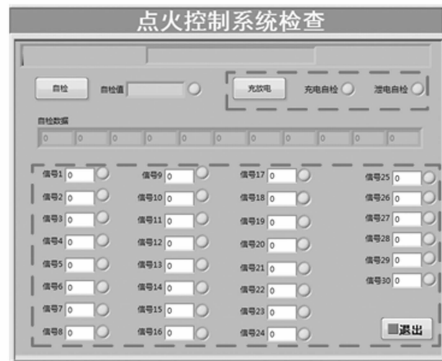
图 10 点火控制系统功能测试软件界面
