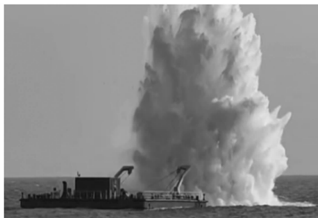
图 6 海上实装水下爆炸冲击试验图
