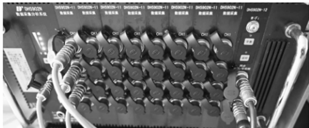
图 2 32 通道高速动态数据采集仪
