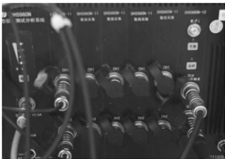
图 3 10 通道压力数据采集仪
