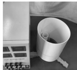
图 10 母弹线圈对单子弹线圈能量传输
