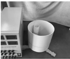
图 12 单母弹线圈对一组同轴放置的子弹线圈能量传输
