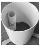
(b) 同轴放置的子弹线圈间耦合系数测量模型
