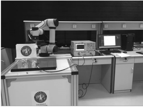
图 7 机械臂毫米波天线测试系统场景图
