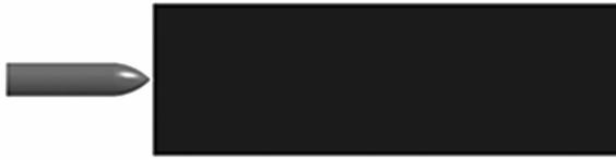
图 1 600 kg 战斗部侵彻 6 m C40 混凝土厚靶板模型
