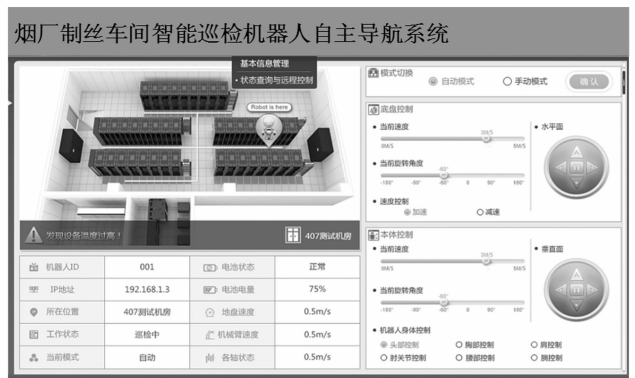
图 8 烟厂制丝车间智能巡检机器人自主导航系统软件界面图
