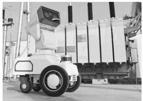
图 9 RW100 型智能巡检机器人示意图
