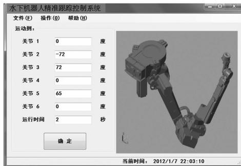
图 6 水下机器人精准跟踪控制系统软件界面图
