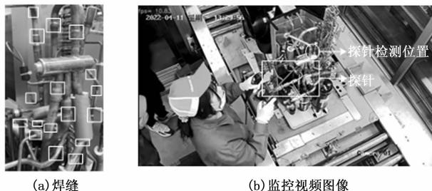
图1 空调外机焊缝检测
