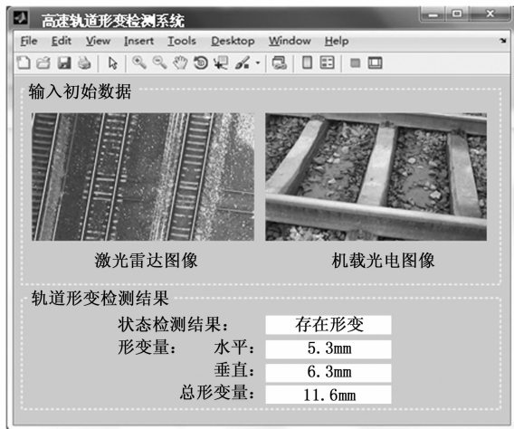
图 9 高速轨道形变检测系统输出界面
