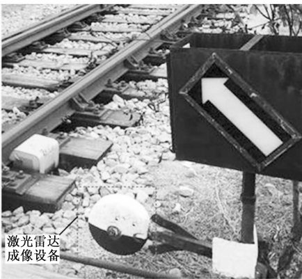
图 7 激光雷达成像设备布设实景
