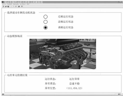
图 5 混合动力车辆发动机电控单元检测系统运行界面
