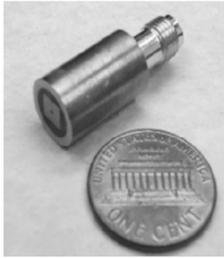
图 3 ZnO 薄膜超声换能器
