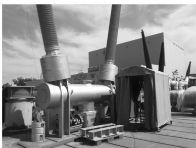
图 10 基于 550 kV 高压开关的选相控制试验平台
