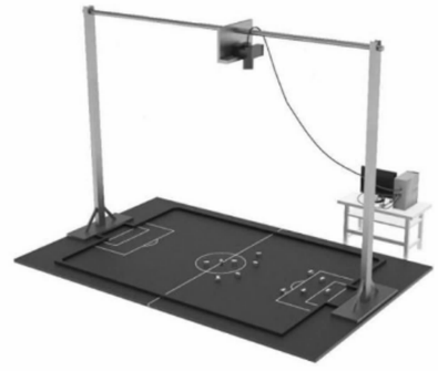
图 1 足球机器人全局视觉系统
