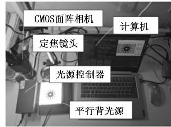
图 1 基于机器视觉的尺寸测量装置
