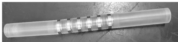
图 8 安装有电极阵列的模拟套管
