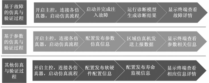
图 4 仿真试验流程设计
