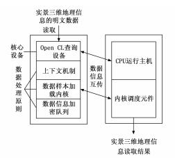
图 1 CPU 主机端调度模块结构图
