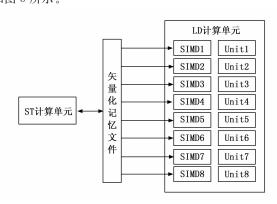
图 5 矢量化计算单元结构模型
