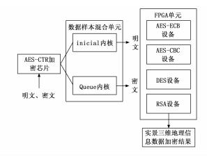
图 4 混合加密模块设计原理
