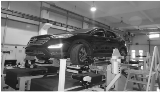
图 7 悬架 K&C 特性试验台
