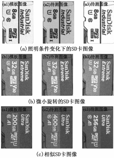
图 2 生产过程中复杂多样的 SD 卡图像
