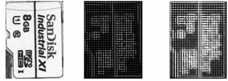
(a) 原图 (b) 传统 HOG 特征 (c) 四方向 HOG 特征 图 7 传统 HOG 特征与四方向 HOG 特征效果对比
