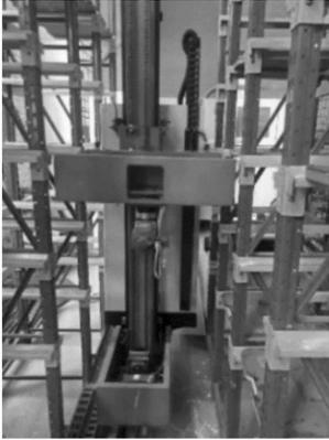
图 5 单立柱式堆垛机
