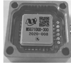
图 2 组合通用单片机的陀螺仪
