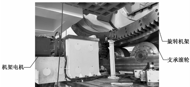
图 12 现场试验控制电机图
