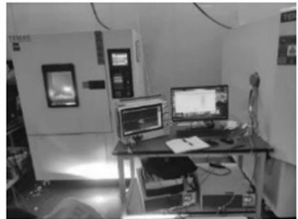
图 6 车灯电流测试实验
