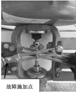
图 8 气动调节阀反馈杆松动故障模拟
