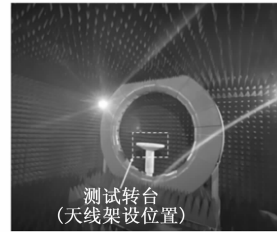
(b) 暗室多探头近场扫描场景
