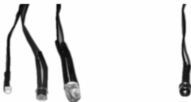
图 2 光源及探测器(左边为光源、右边为探测器)
