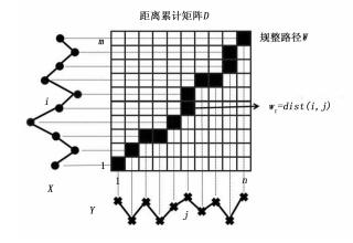
图 1 DTW 算法匹配规整路径与距离累计矩阵
