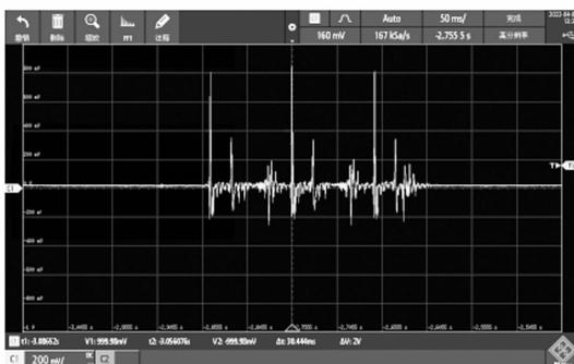
图 5 三连发射击后坐加速度波形
