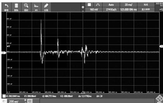
图 4 单发射击后坐加速度波形
