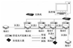
图 1 现场监测系统布置示意图
