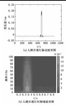
图 4 人踏步通行振动信号变化图
