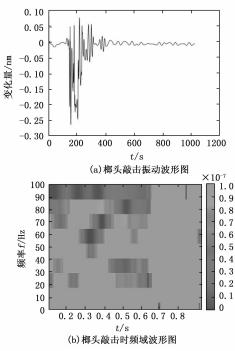
图 7 榔头敲击振动信号变化图
