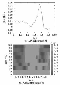
图 5 人跳跃振动信号变化图
