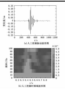
图 6 人工挖掘振动信号变化图
