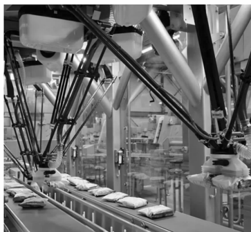
图 6 机械臂分拣过程实物图
