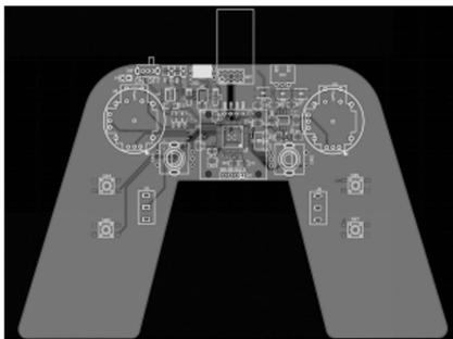
图 2 基于 STM32 的上位机控制器 PCB
